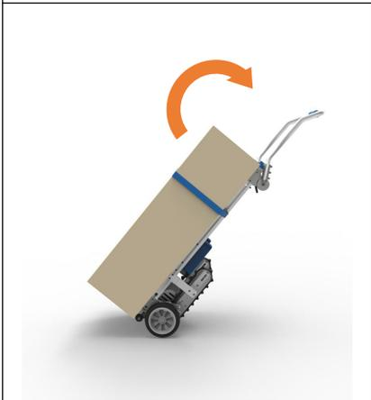
Ajuste os apoios de braços no condições adequadas, incline o máquina no ângulo adequado e Manter o equilíbrio.
